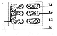
L-N – 120 VAC 1Ø 60 Hz L-N – 110 VAC 1Ø 60 Hz SERIES WYE (STAR)
